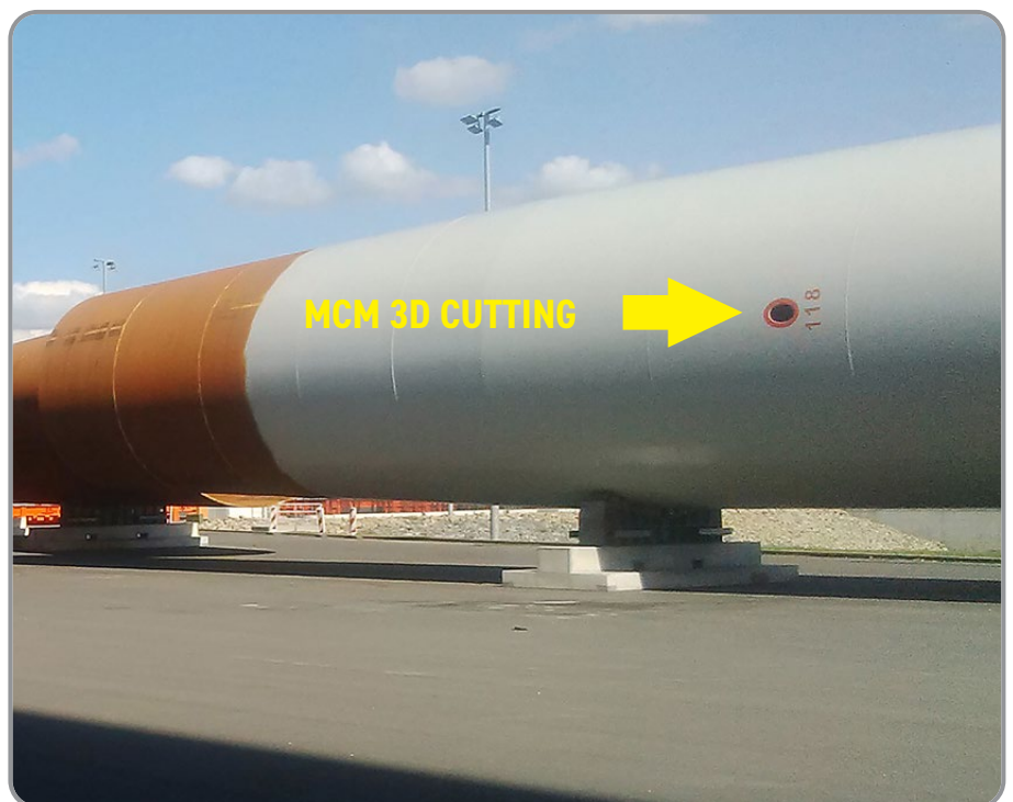
Gesamtansicht des XL-Monopiles
