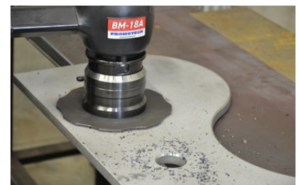
Anfasen von Kreisabschnitten ab 40mm Durchmesser
