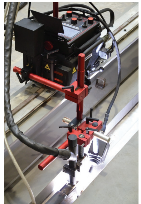
Nahtführung funktioniert mit und ohne Oszillation
