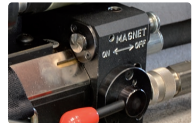
Schutz gegen Anlaufen des Motors, wenn die Magnetbasis nicht aktiviert ist
