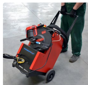
tragbare Hydraulikstation mit Ablage zum Transport der Lochstanze
