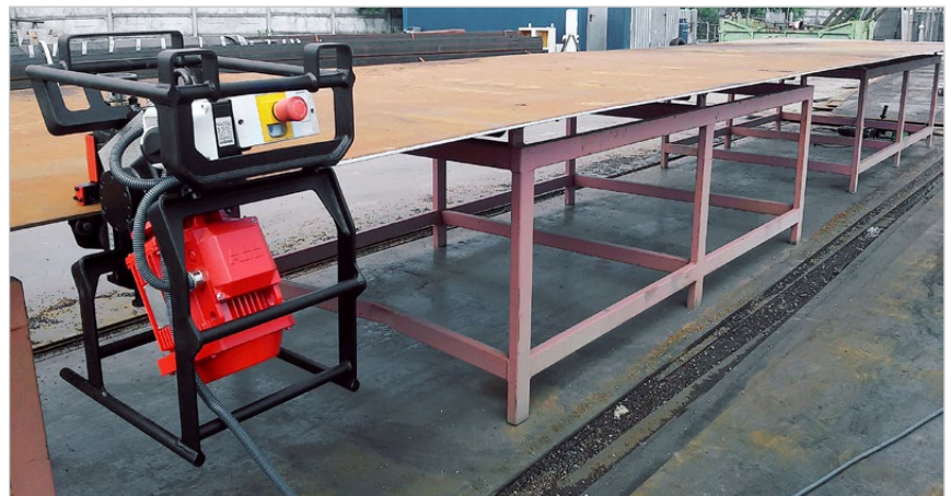
ABM-14 läuft automatisch an der Platte entlang
