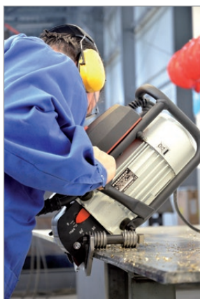
Fasen von Blechen
