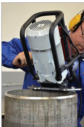
Fasen von Rohren
