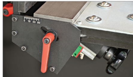
Einfache Einstellung der Fasenbreite
