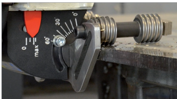
stufenlose Winkeleinstellung von 0° bis 60°
